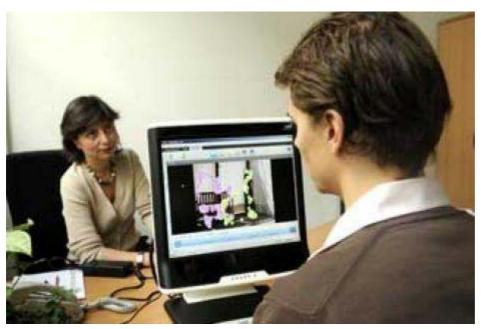
© Philippe Maeder | Le dispositif utilisé à l'EPFL dans le groupe de la prof. Nouchine Hadjikhani (à g.) permet de suivre l'activité visuelle des sujets devant une image destinée à susciter des émotions. L'analyse permet ensuite d'en savoir plus sur le type d'autisme.
